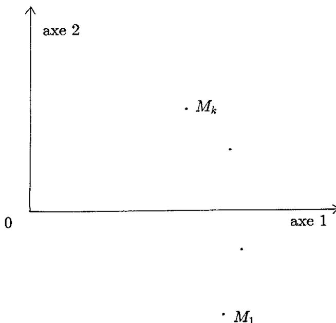
Sur ce graphique, le cosinus de l'angle entre les vecteurs  $OM_k$  et  $OM_l$  est l'approximation du produit scalaire normé entre  $W_k$  et  $W_l$ , appelé coefficient RV. Un coefficient RV proche de 1 signifie qu'on a la même structure des individus à l'intérieur des tableaux  $X_k$  et  $X_l$ , et que par conséquent les positions mutuelles des individus sont les mêmes dans les conditions k et l.
