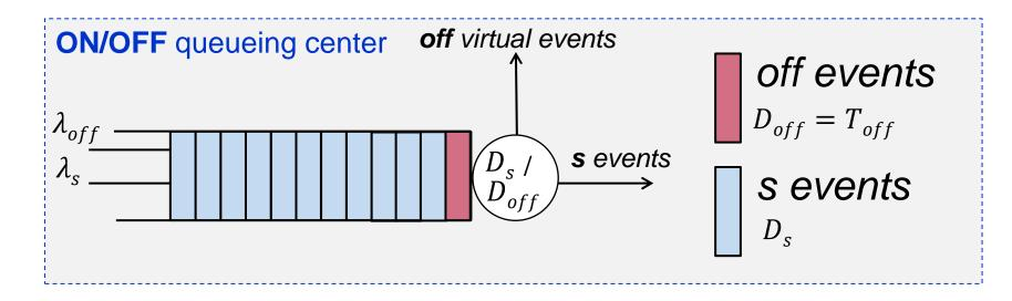
$$R_{\rm s}^{on/off} = \frac{\frac{T_{\rm OFF}^2}{T_{\rm ON} + T_{\rm OFF}} + D_{\rm s} \frac{T_{\rm ON} + T_{\rm OFF}}{T_{\rm ON}}}{1 - \lambda_{\rm s} D_{\rm s} \frac{T_{\rm ON} + T_{\rm OFF}}{T_{\rm ON}}}$$
