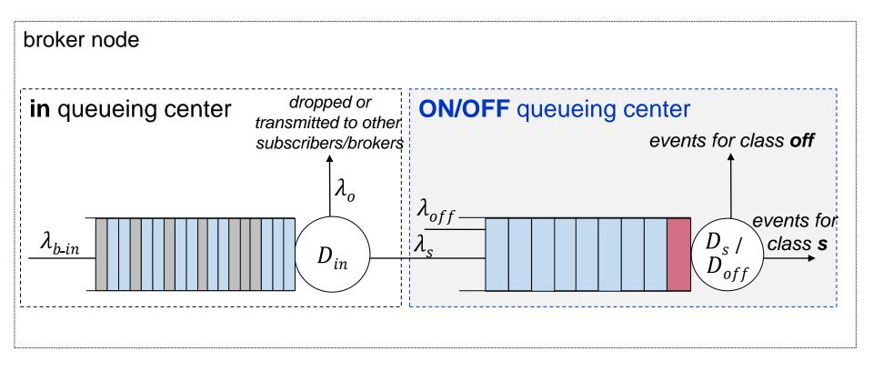
$$R_{\rm s}^{\rm in} = \frac{D_{\rm in}}{1 - \lambda_{\rm b\_in} D_{\rm in}} + R_{\rm s}^{on/off} = \frac{\frac{T_{\rm OFF}^2}{T_{\rm ON} + T_{\rm OFF}} + D_{\rm s} \frac{T_{\rm ON} + T_{\rm OFF}}{T_{\rm ON}}}{1 - \lambda_{\rm s} D_{\rm s} \frac{T_{\rm ON} + T_{\rm OFF}}{T_{\rm ON}}}$$
